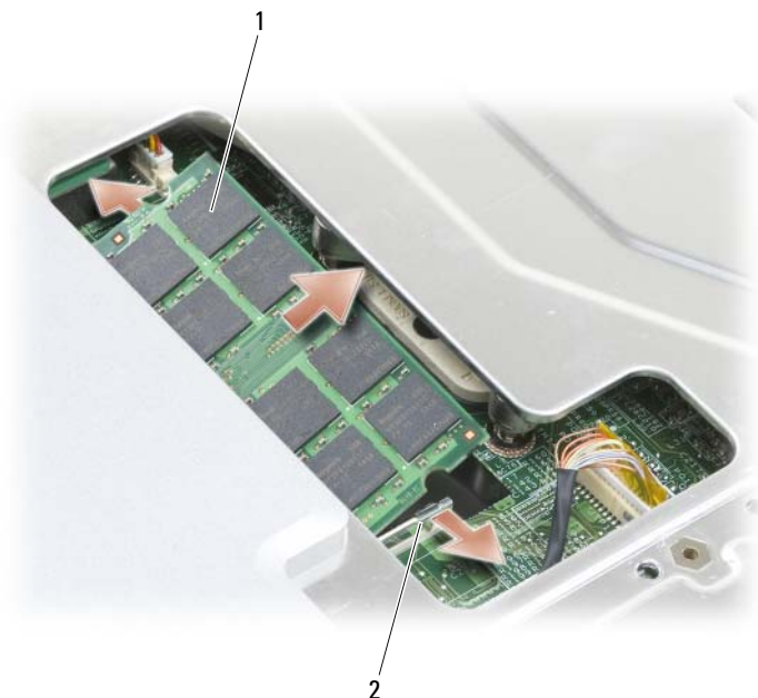
1 Módulo de memoria (DIMM A) 2 Ganchos de fijación (2)
